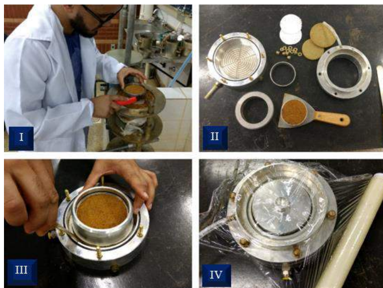
Figura 1. Etapas da montagem dos corpos de prova e célula de adensamento I – Coleta da amostra indeformada; (II) Componentes da célula endométrica; (III) Montagem da célula endométrica; (IV) Célula endométrica montada com proteção para perda de umidade
