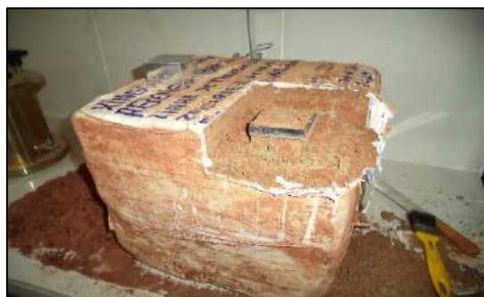
Figura 6. Talhagem da amostra em caixa 5 x 5 cm
